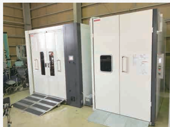
カゴ台車のままで、ベッドフレームが洗浄・乾燥可能に（プライムケア中京様）
